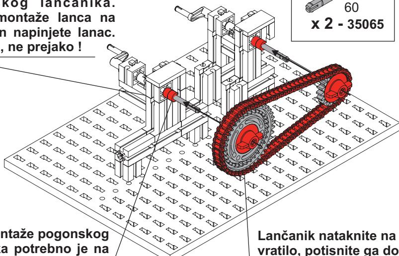
Prije montaže pogonskog lančanika potrebno je na vratilo staviti odstojnike.
