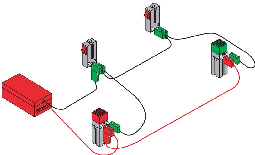
**Način spajanja uz napajanje adapterom 220V - 9V putem regulatora napona "Power Controlera", isto i uz napajanje Fischerovom baterijom koja se može puniti.**
